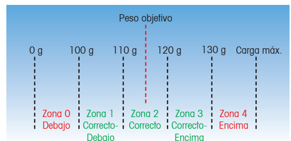
Figura 11.1: Límites de zona de la controladora de peso
