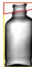
Figura 7: Detección de tapón faltante
