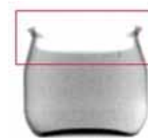
Figura 15: Tarro de yogurt con bajo nivel de llenado
