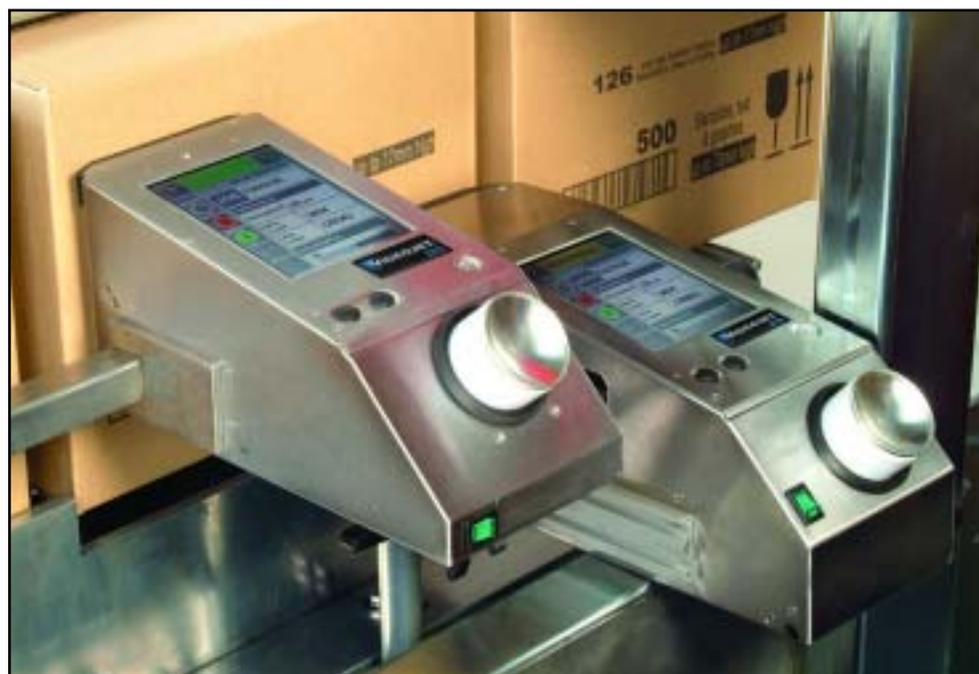
Estos sistemas pueden conseguirlo porque son los únicos codificadores inkjet en alta resolución que limpian y mantienen automáticamente el cabezal con un proceso único y patentado de micropurgado en todas las impresiones, sin afectar a la velocidad de producción ni al rendimiento total. Una tecnología única que crea confianza en la calidad de la impresión.
